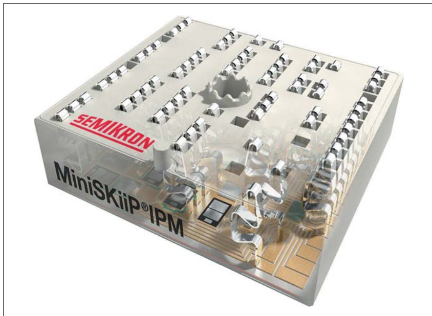
Рис. 1. Модули MiniSKiiP IPM в 2 раза меньше аналогичных компонентов данного диапазона мощности
